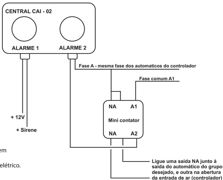
**OBS:** Ligue o ALARME 1 em paralelo com o alarme convencional do quadro elétrico.
